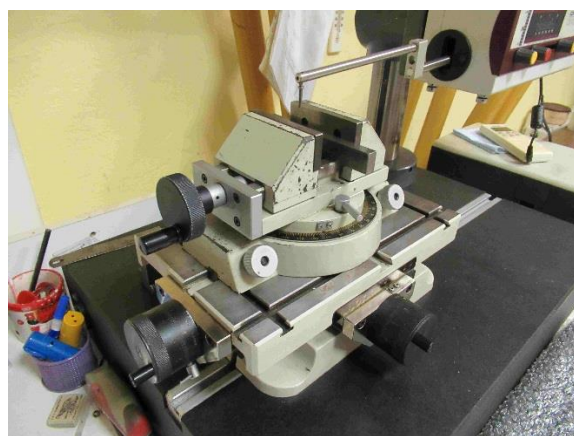
Upínací sekce měřené součástky a snímací čidlo tvaru
