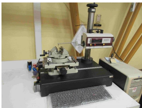
Konturoměr Mitutoyo Contracer CV-1000
