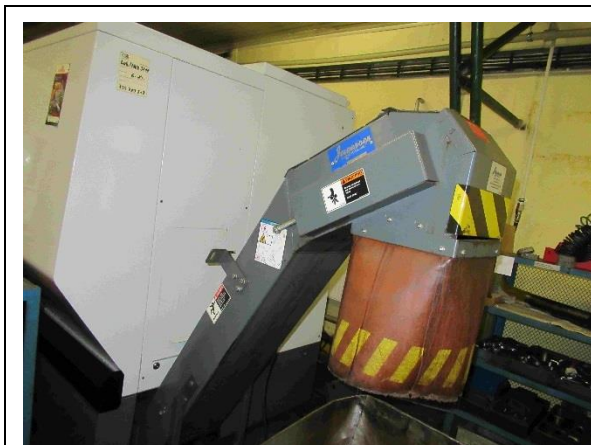
Dopravník třískového hospodářství
