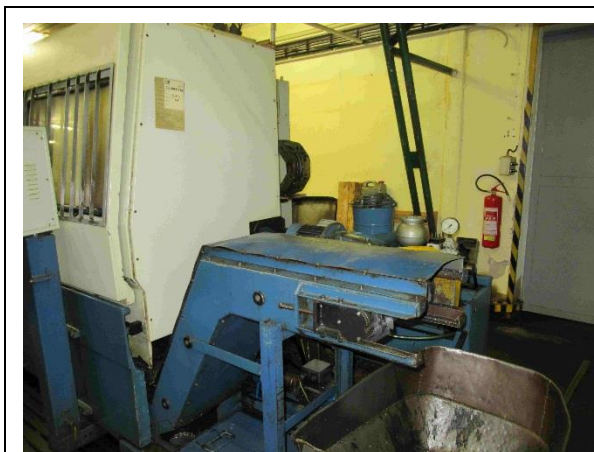
Pohled na třískové hospodářství soustruhu
